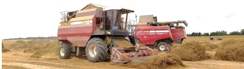
Рис. 1.4. Обмолот вороха льна на оборудованных площадках в поле зерноуборочными комбайнами с приставкой ПЗ-3,4
