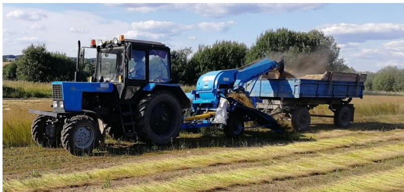
Рис. 3.18. Общий вид льноуборочного комбайна «Двина-4М» с роторно-бильным аппаратом
