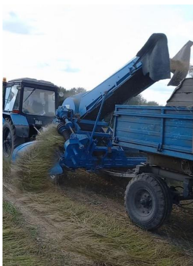
Рис. 5.3. Рабочий процесс льноуборочного комбайна «Двина-4М» с роторно-бильным аппаратом
