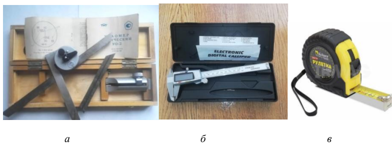
Рис. 3.2. Измерительные инструменты для определения угла перекоса и диаметра стеблей в ленте льна:
