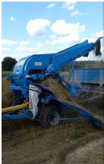
Рис. 5.3. Рабочий процесс льноуборочного комбайна «Двина-4М» с роторно-бильным аппаратом
