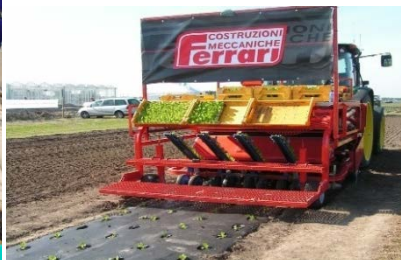
Рис. 18.8. Многофункциональная машина для посадки земляники
