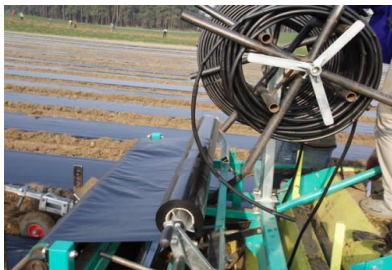
Рис. 18.8. Многофункциональная машина для посадки земляники
