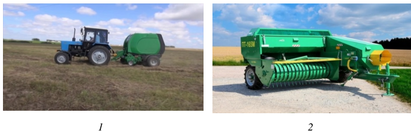
Рис. 26.4. Пресс-подборщики: 1 – ПРИ-150; 2 – ППТ-165М
