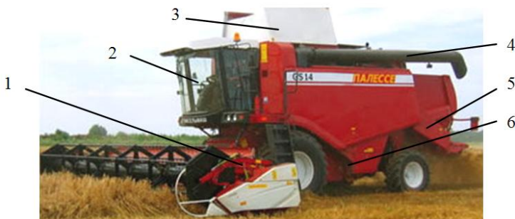
Рис. 17. Зерноуборочный комбайн ПАЛЕКСЕ GS14: 1 – жатка; 2 – площадка с кабиной управления; 3 – бункер; 4 – шнек выгрузной; 5 – соломоизмельчитель; 6 – система обмолота и очистки
