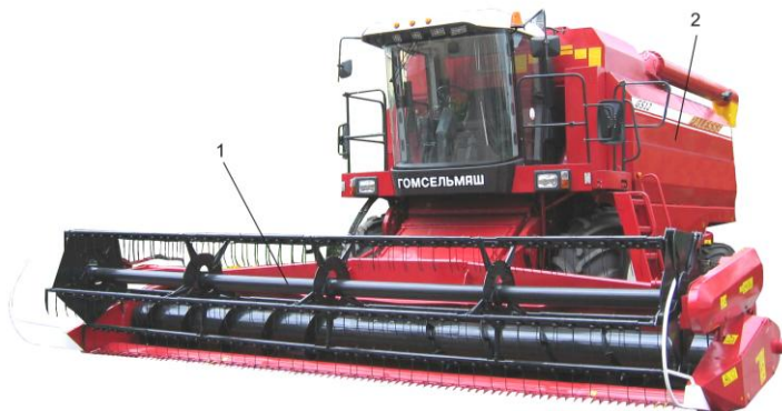
Рис. 9. Зерноуборочный комбайн ПАЛЕССЕ GS12: 1 – жатка для зерновых культур; 2 – молотилка самоходная
