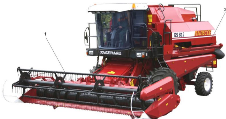
Рис. 12. Зерноуборочный комбайн ПАЛЕКСЕ GS812: 1 – жатка для зерновых культур; 2 – молотилка самоходная
