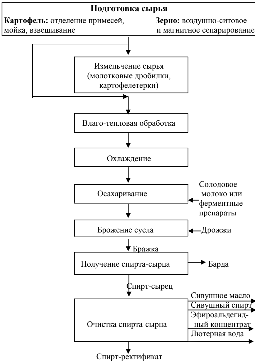
Рис. 33. Технологическая схема получения спирта-ректификата
