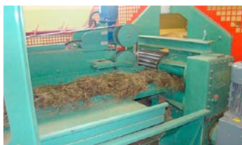
Рис. 30. Линия по производству длинного волокна: a – общий вид; б – загрузка рулонов на линию; в – формирование слоя; г – мяльная машина; д – длинное волокно
