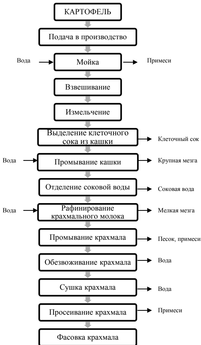
Рис. 32. Технологическая схема производства картофельного крахмала
