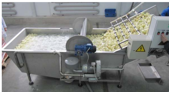
Рис. 14. Вентиляторная моечная машина
