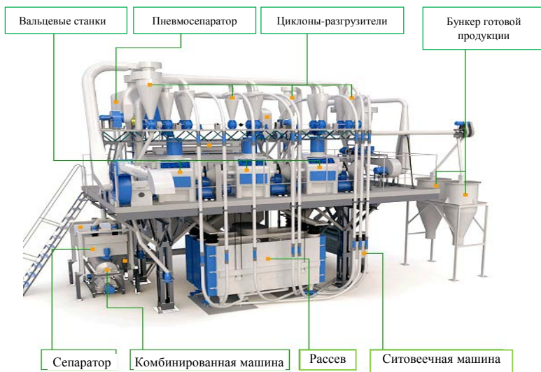
Рис. 7. Оборудование современной мельницы
