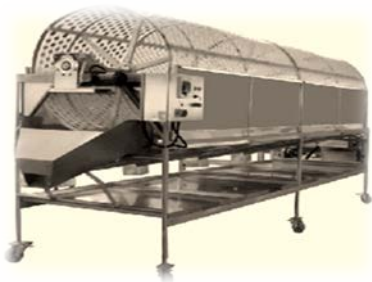
Рис. 16. Барабанная сортировочная машина
