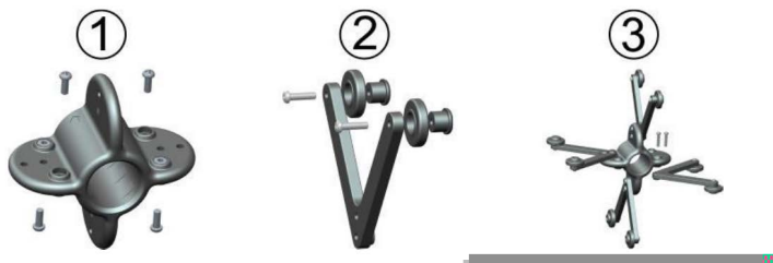
Рис. 22.6. Последовательность сборки и установки направляющих
