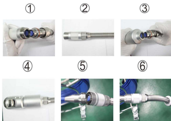
Рис. 22.5. Последовательность подключения видеокамеры
