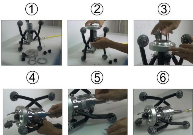
Рис. 22.7. Порядок установки телескопической направляющей
