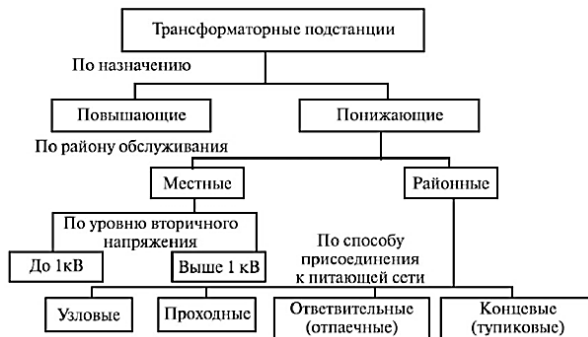
Рис. 1. Классификация трансформаторных подстанций
