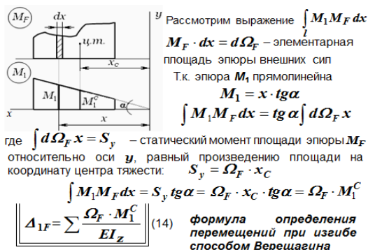
Рис. 2. Вывод формулы определения перемещений способом Верещагина
