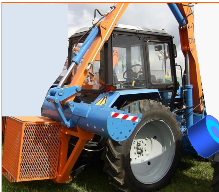
Рис. 2.79. Каналоочиститель многоцелевой ОКН с рабочим органом в транспортном положении.
