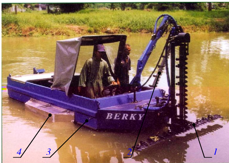
Рис. 3.94. Косилка с основным Т-образным и дополнительным боковым рабочими органами.
