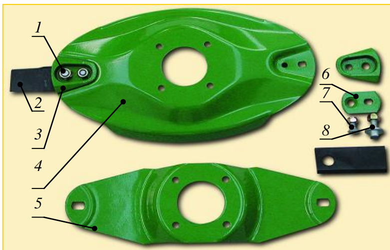
Рис. 3.50. Детали ротора косилок фирм Claas и Krone.
