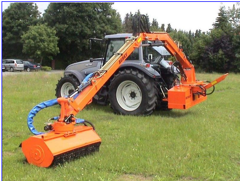
Рис. 3.62. Косилка-измельчитель с рабочим органом, навешенным сзади.
