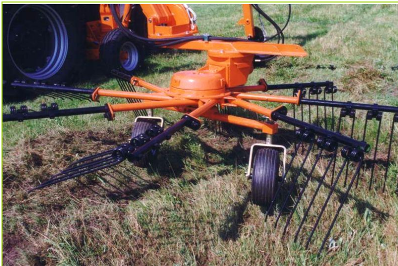
Рис. 3.76. Роторный рабочий орган с гидроприводом подборщика срезанной растительности.
