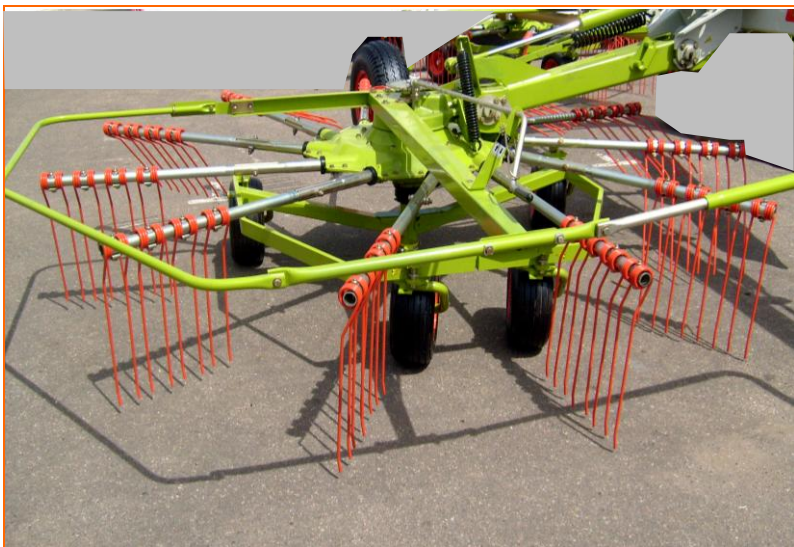
Рис. 3.77. Ротационный грабельный рабочий орган с механическим приводом.
