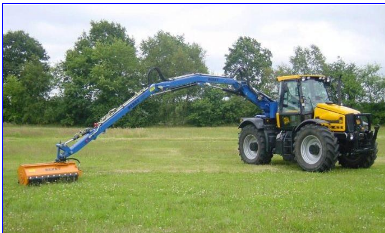
Рис. 3.60. Косилка-измельчитель на поворотной платформе.
