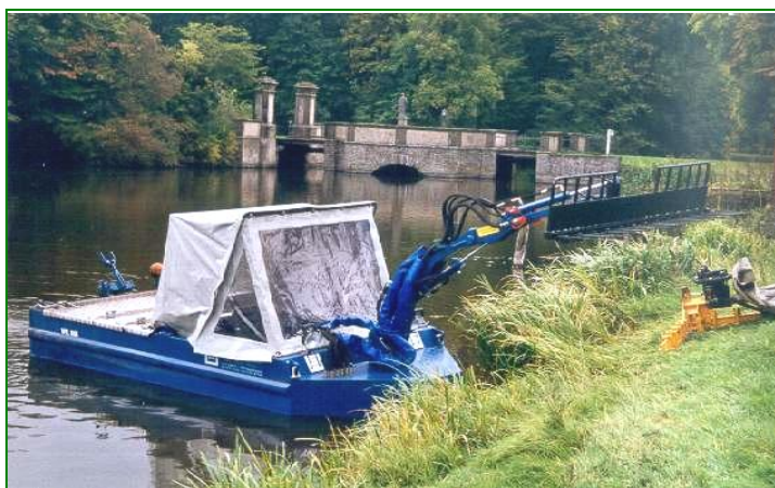
Рис. 3.101. Мотобот для сбора срезанной растительности.
