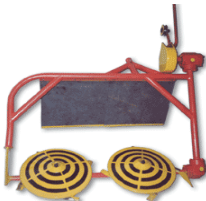
Рис. 3.36. Сменный фронтальный двухроторный косилочный рабочий орган к мотоблоку.
