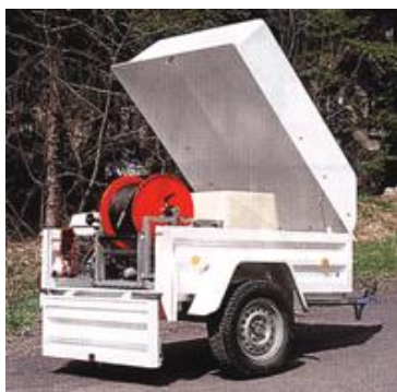
Рис. 4.36. Оборудование для чистки труб: а – на базе прицепа; б – на базе автомобиля.
