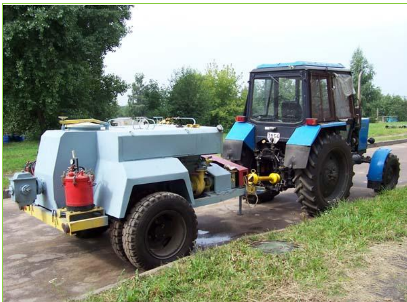
Рис. 5.2. Общий вид агрегата АУГ-3 с трактором в транспортном положении.
