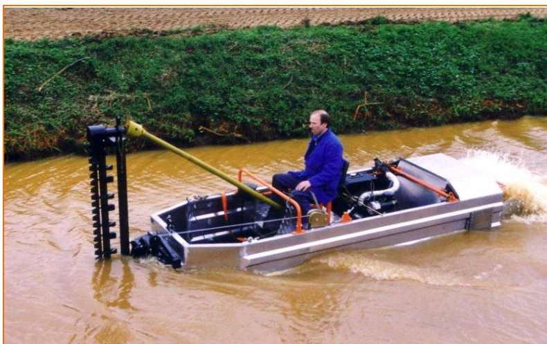
Рис. 3.87. Косилка с Т-образным рабочим органом.
