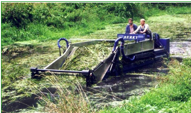
Рис. 3.103. Плавающие косилки с накопителями срезанной растительности.
