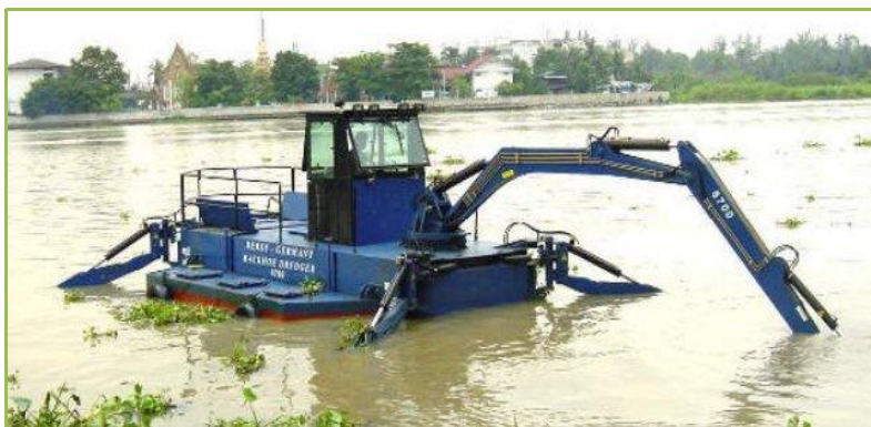
Рис. 2.57. Плавучая машина с аутригерами.
