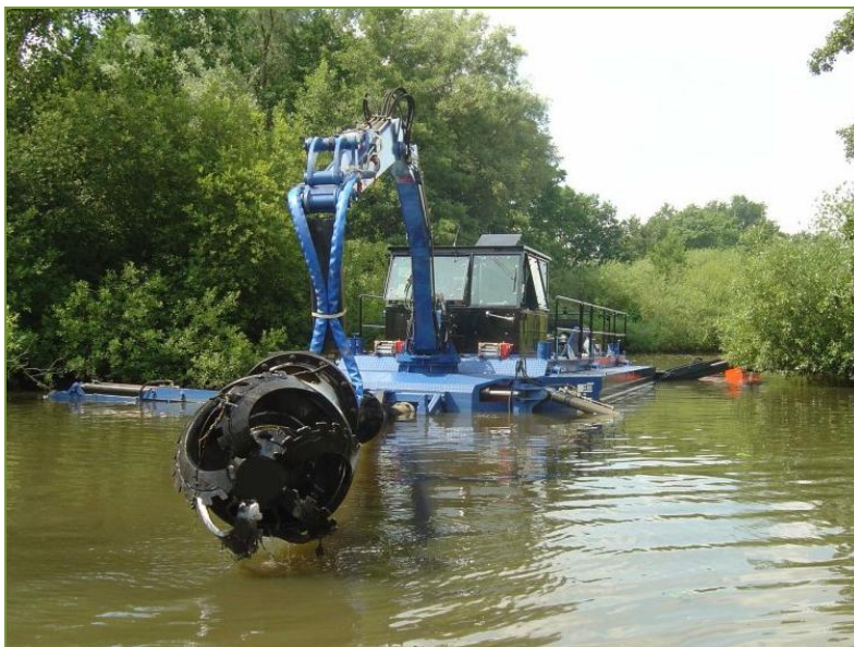
Рис. 6.7. Земснаряд с независимым поворотом грунтозаборного органа и выносными донными колесными опорами.
