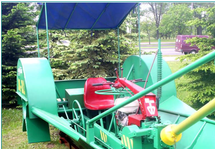
Рис. 3.90. Рабочий пост управления лодкой-косилкой ЛК-12.
