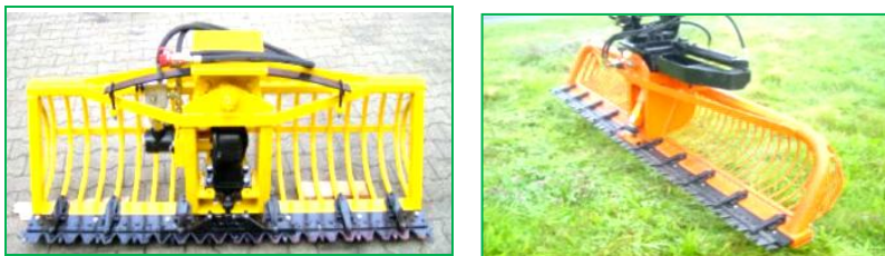
Рис. 3.67. Рабочие органы наклоняемых ковшей-косилок.
