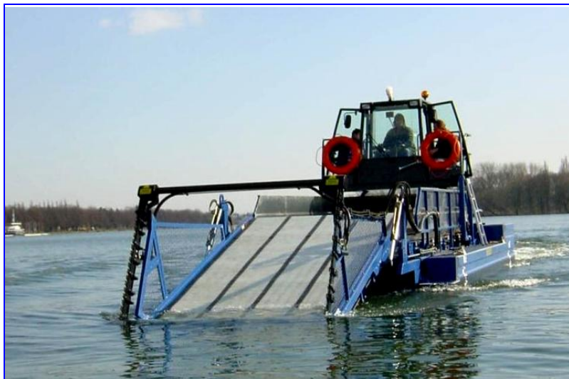
Рис. 3.106. Вид плавучего комбайна для удаления водной растительности.
