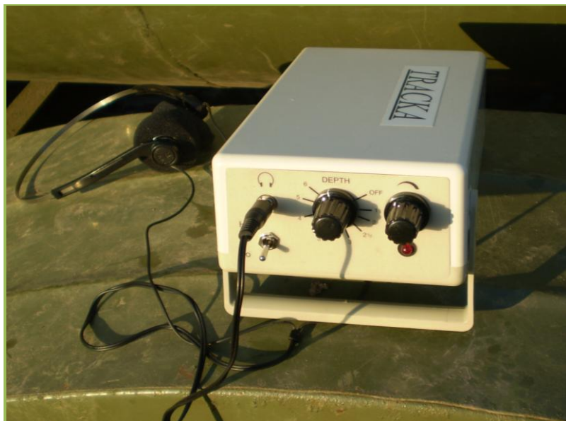
Рис. 4.39. Прибор для определения положения дренапромывочной головки.
