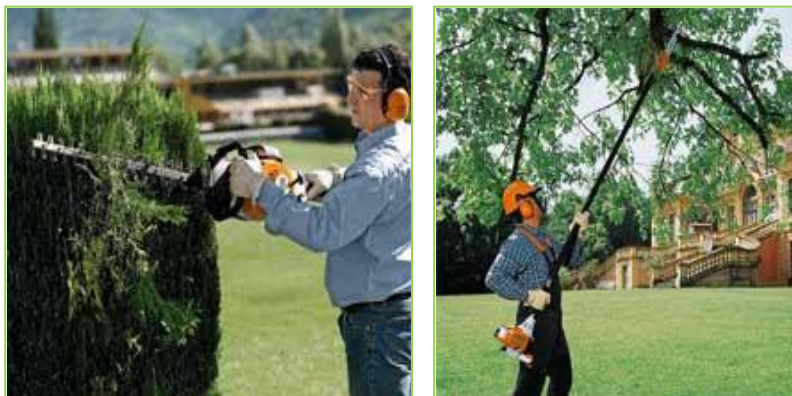
Рис. 3.70. Работа ручными косилками: а – с сегментным рабочим органом; б – высоторезом.
