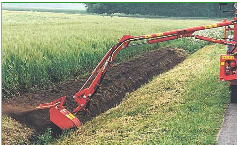
Рис. 2.17. Процесс очистки канала при наличии вблизи расположенных посевов.
