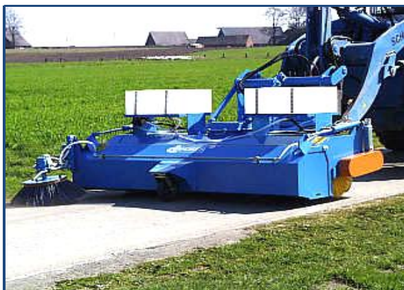
Рис. 2.29. Общий вид машины с цилиндрической щеткой и щеткой-фрезой.
