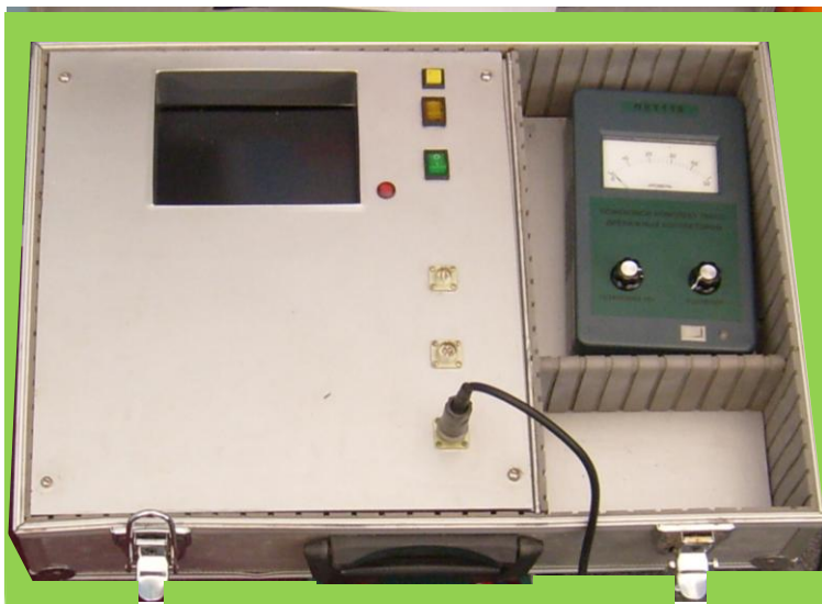
Рис. 4.43. Пульт управления с открытой крышкой комплекса КСД-160.
