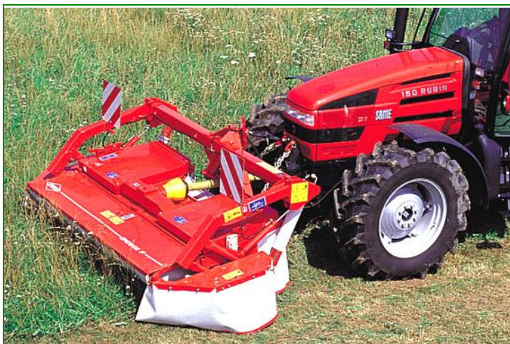
Рис. 3.56. Вариант многороторной косилки с фронтально навешенным режущим аппаратом.
