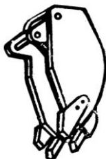
Рис. 4.2. Специальный ковш с удлиненными крайними зубьями.
