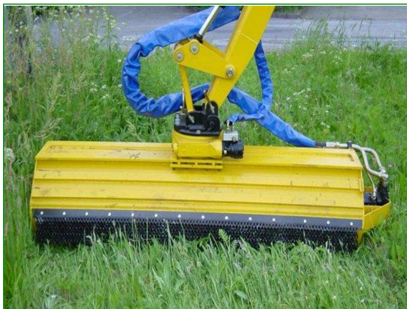
Рис. 3.59. Рабочий орган косилки-измельчителя.
