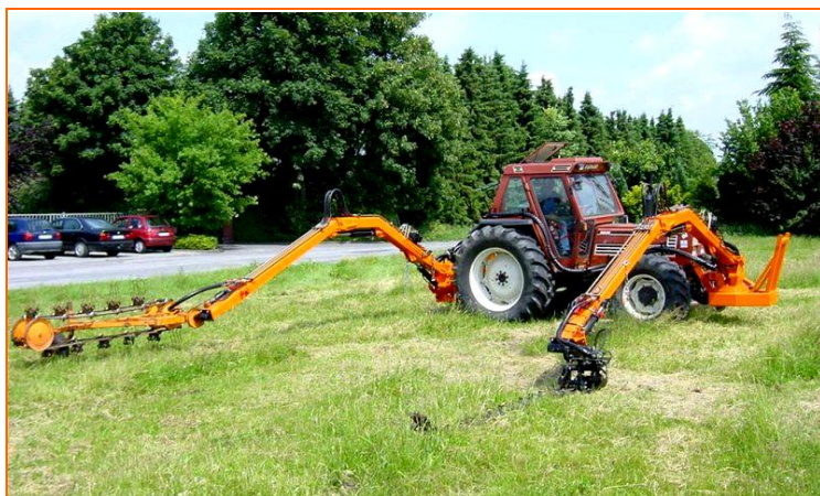
Рис. 3.79. Косилки с сегментным косилочным с изогнутым брусом и грабельным цепным рабочим органом.
