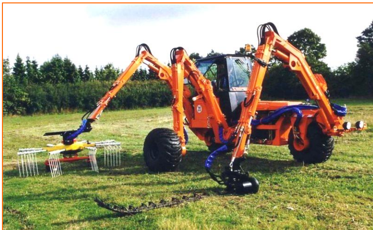
Рис. 3.80. Косилки с сегментным косилочным с изогнутым брусом и роторным грабельным рабочим органом.
