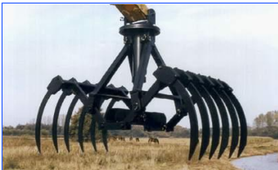
Рис. 2.63. Многозубый двухчелюстной захват.
