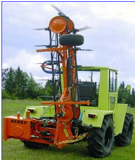
Рис. 3.74. Общий вид цепного подборщика в транспортном положении.
