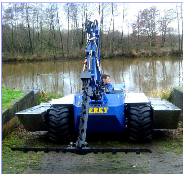
Рис. 3.100. Косилка-амфибия на колесном ходу.
