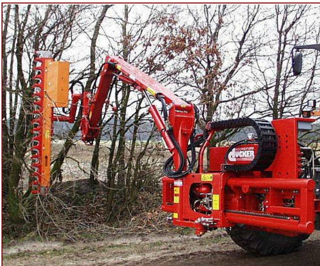
Рис. 3.19. Ножницы-кусторез на базе автомобиля.
