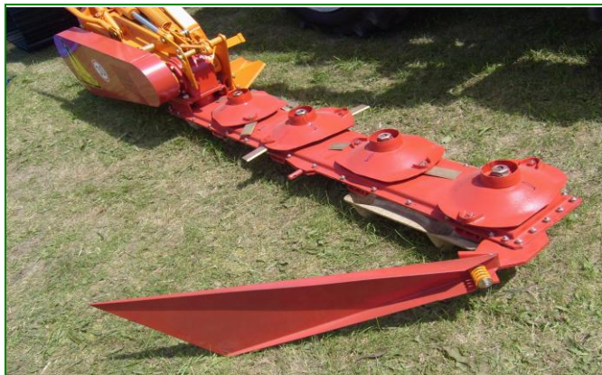
Рис. 3.40. Рабочий органа многороторной косилки АС-1.
