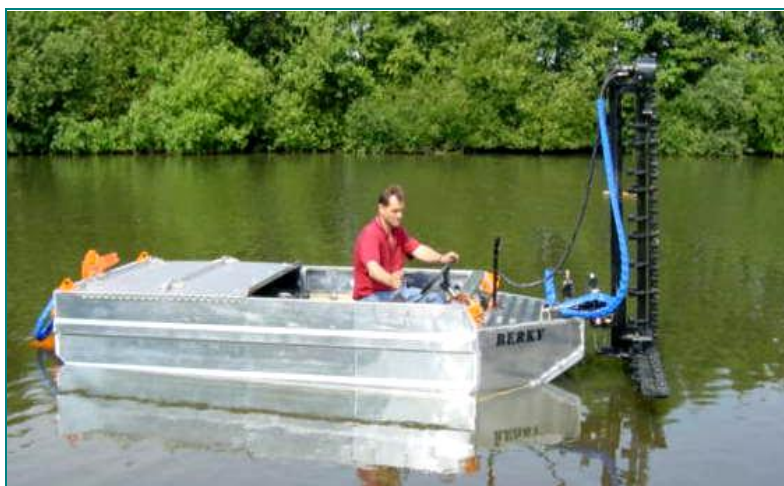
Рис. 3.92. Лодка-косилка с Т-образным рабочим органом.
