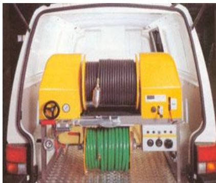
Рис. 4.36. Оборудование для чистки труб: а – на базе прицепа; б – на базе автомобиля.
