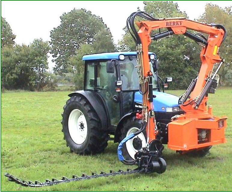
Рис. 3.11. Косилка с изогнутым двухножьевым режущим аппаратом.
