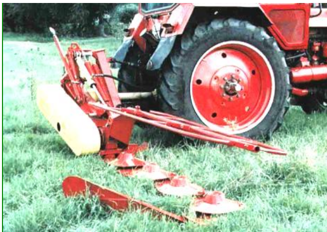
Рис. 3.38. Четырехроторная косилка КДН-210.
