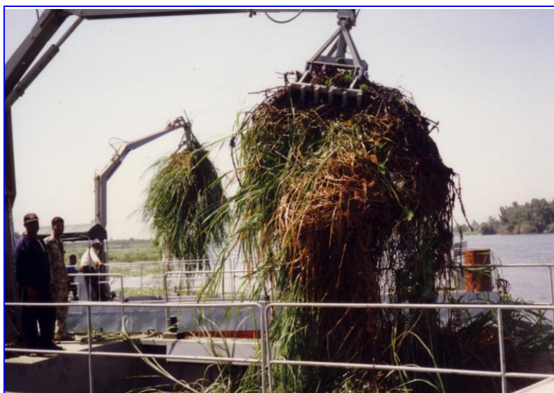
Рис. 3.107. Процесс выгрузки из бункера срезанной водной растительности.
