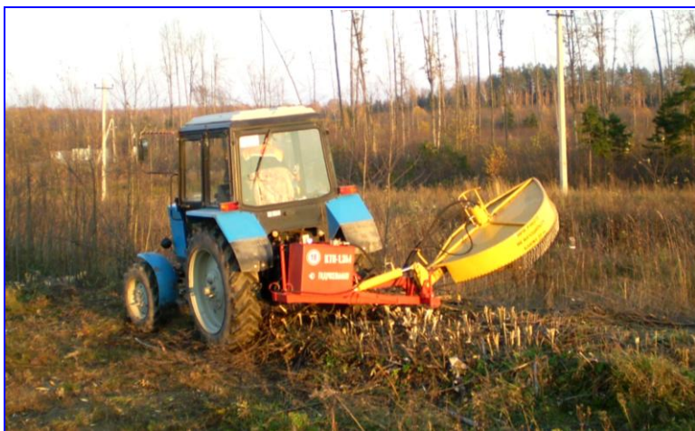
Рис. 3.22. Однороторная четырехножевая косилка КР-1,3.
