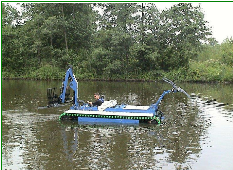
Рис. 3.102. Мотобот-амфибия для сбора срезанной растительности на гусеничном ходу.
