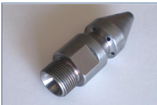
Рис. 4.18. Общий вид реактивной головки УПД-120.
