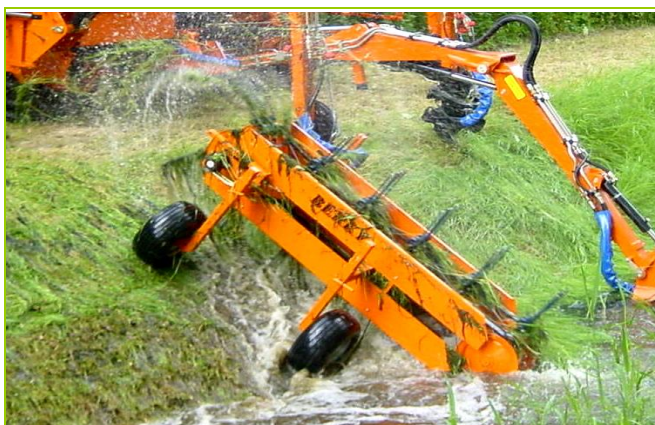
Рис. 3.75. Общий вид рабочего органа цепного подборщика в рабочем положении.
