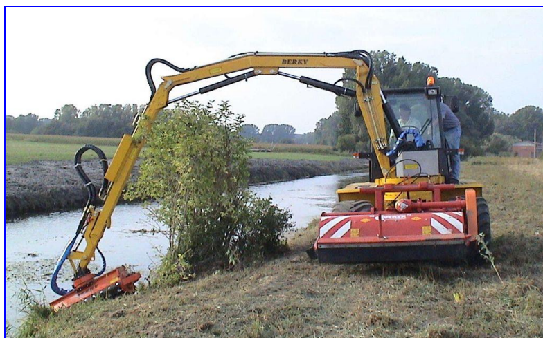
Рис. 3.63. Косилка-измельчитель с рабочими органами, навешенными фронтально и сбоку.
