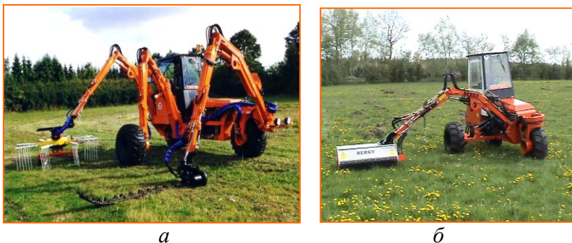
Рис. 2.48. Трехопорные каналоочистители фирмы Verku.
