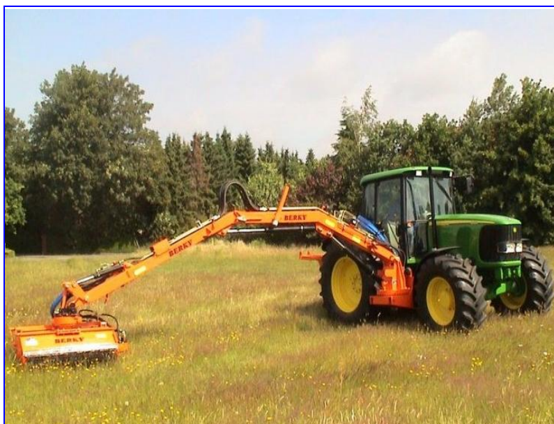
Рис. 3.61. Косилка-измельчитель с рабочим органом, навешенным сбоку.
