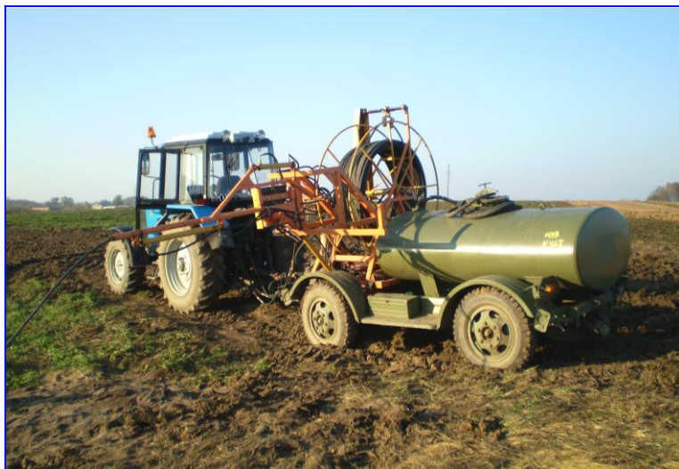
Рис. 4.29. Общий вид установки для промывки дренажа ДП-10А.
