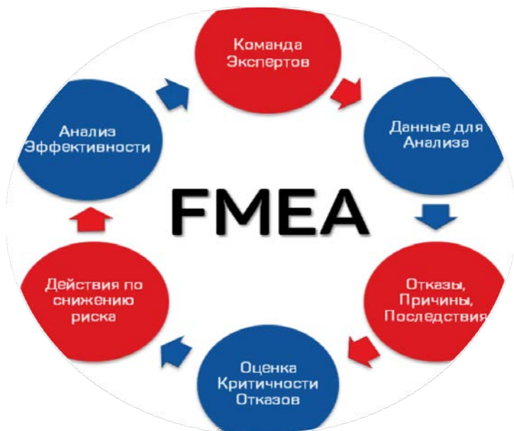
Рис. 1. Концептуальная классическая схема FMEA-анализа Источник: [13, 14]
