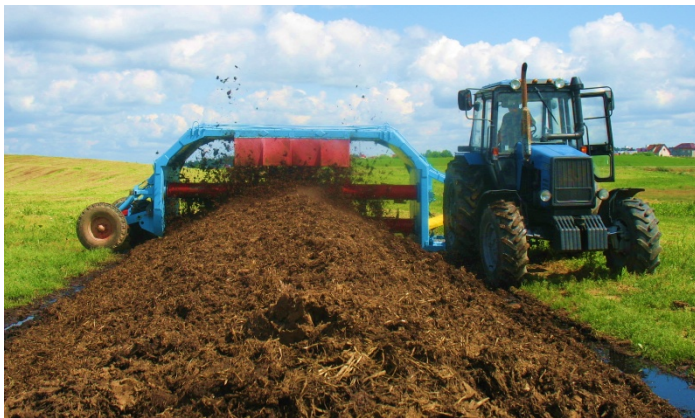
Рис. 2.2. Аэратор-смеситель АСК-3,5 в работе
