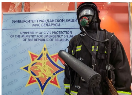
Рис. 3. «Установка для распыления твердых сыпучих материалов при ликвидации чрезвычайных ситуаций, связанных с розливом жидких агрессивных сред Silver Edge»
