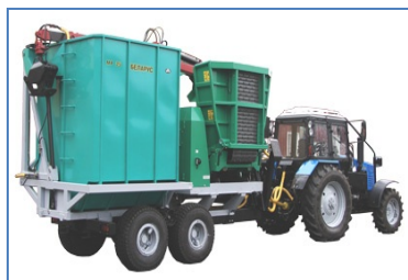
Рис. 5.11. Машина рубильная БЕЛАРУС МР-25: а – МР-25-02 – с контейнером-накопителем (бункером) для щепы; б – МР-25-03 – без контейнера-накопителя
