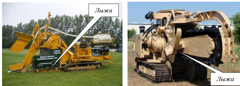
Рис. 2.56. Цепные скребковые экскаваторы-дреноукладчики с опорными устройствами рабочего органа
