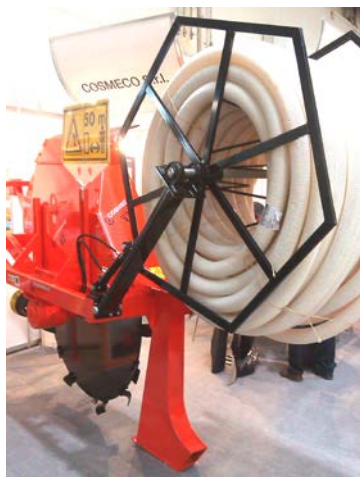
Рис. 2.58. Дисковый скребковый рабочий орган экскаватора-дреноукладчика фирмы Cosmesco
