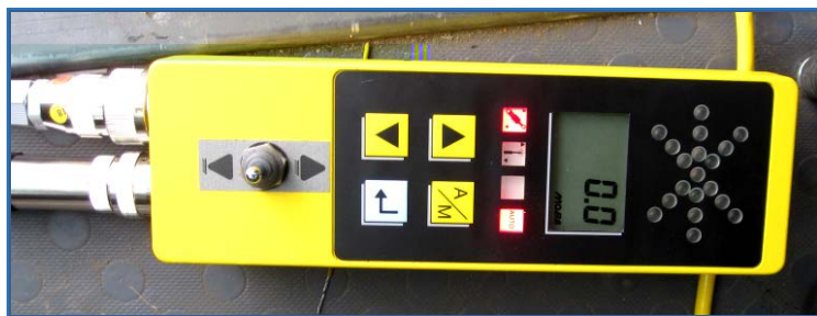
Рис. 3.15. Пульт управления лазерной системы ЭТЦ-203
