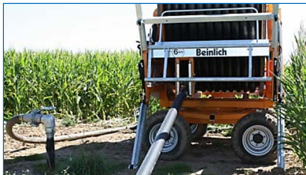
Рис. 6.17. Установка с поворотным барабаном
