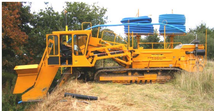
Рис. 2.54. Цепной скребковый экскаватор-дреноукладчик с бункером для обсыпания дренажной трубы и перемещающейся кабиной
