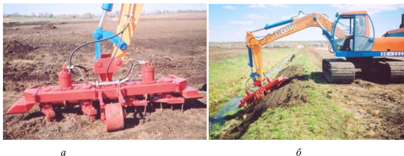
Рис. 4.18. Планировщик-рыхлитель на ЭО-3223: a – работа фрез; б – планировщик-рыхлитель в работе
