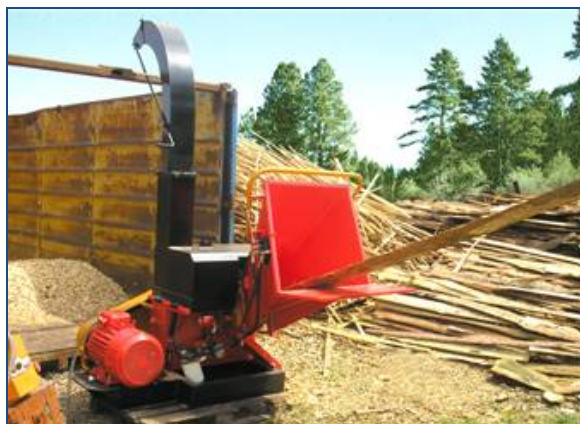
Рис. 5.8. Стационарная машина DP 660 E с электроприводом в работе
