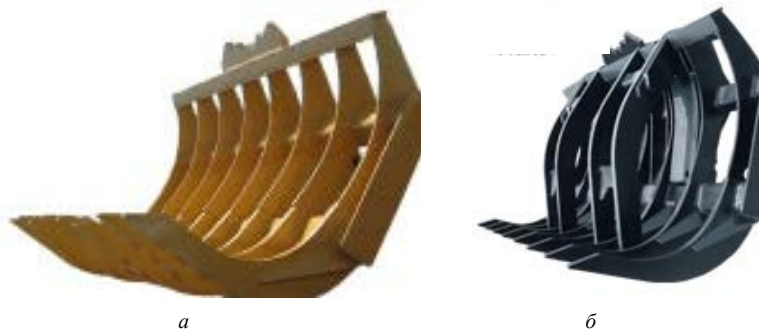
Рис. 5.42. Корчующие рабочие органы с зубьями специальной формы ( а ) и с зубьями специальной формы и прижимными рычагами ( б )
