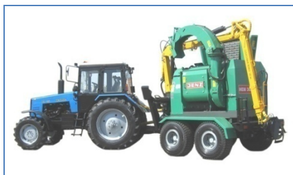
Рис. 5.11. Машина рубильная БЕЛАРУС МР-25: а – МР-25-02 – с контейнером-накопителем (бункером) для щепы; б – МР-25-03 – без контейнера-накопителя
