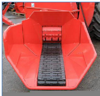
Рис. 5.9. Рубильная машина CH 380 HFC с гидравлическим манипулятором ( а ) и подающим конвейером ( б )
