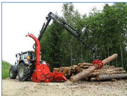
Рис. 5.9. Рубильная машина CH 380 HFC с гидравлическим манипулятором ( а ) и подающим конвейером ( б )
