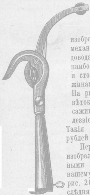
Рис. 18. Ножницы для срѣзанія высоко расположенныхъ сучьевъ.
