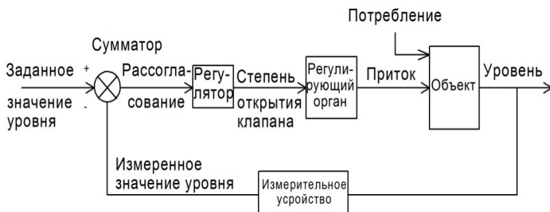
Рис. 7.3. Структурная схема АСР уровня в емкости
