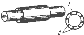
Рис. 16.6. Грязезащитная муфта: 1 – расточенное отверстие; 2 – специальные выступы (2 мм)
