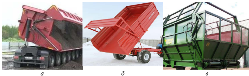
Рис. 1. Системы автоматического открытия бортов: а – Тонар-95236; б – ISON-8507; в – ПС-45
