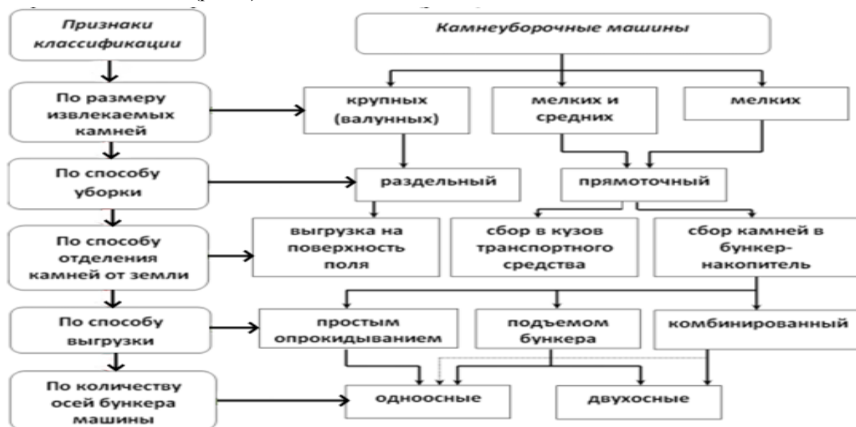
Рис. 5. Классификация камнеуборочных машин
