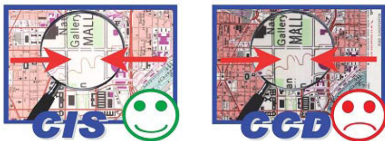
Рис. 7.77. Изображение в местах стыковки соседних CCD-камер
