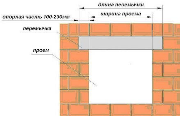
Рис. 7.5. Перемычка в оконном проеме
