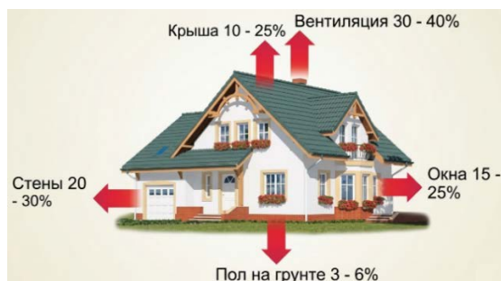
Рис. 1.4. Структура теплотерь жилого дома
