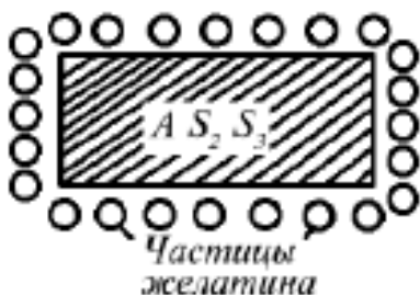
Рис. 32.1. Схема защитного действия желатина
