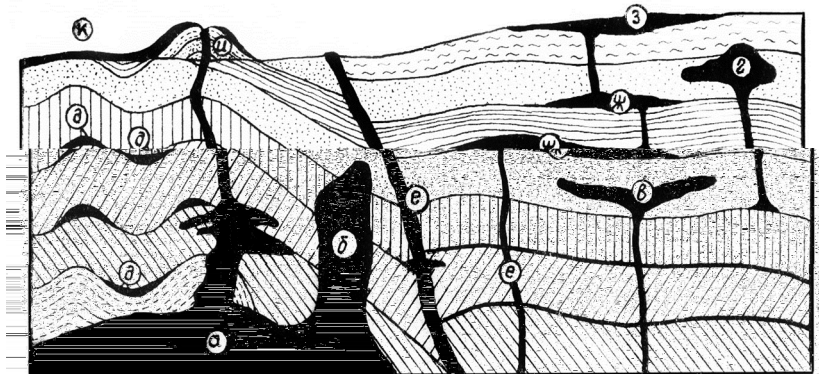
Рис. 2.6. Формы залегания магматических горных пород: а – батолит; б – шток; в – лополит; г – лакколит; д – факолит; е – магматические жилы (дайки); ж – силлы; з – покров; и – вулканический конус; к – лавовый поток
