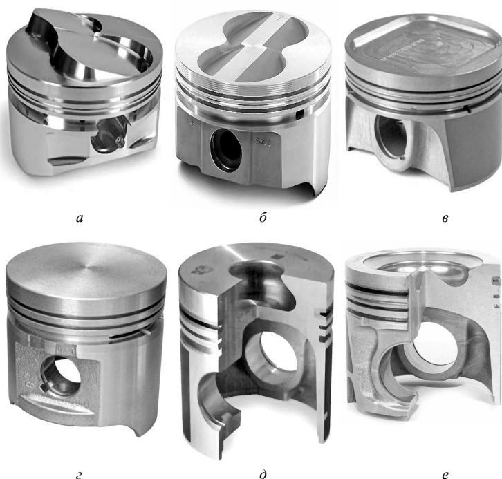
Рис. 3.6. Форма днища поршней: а – с вытеснителем и выемками клапанов; б – с плоским днищем и выемками для клапанов; в – с углубленным днищем; г – с плоским днищем; д – с трапециевидной камерой сгорания; е – с тороидальной камерой сгорания
