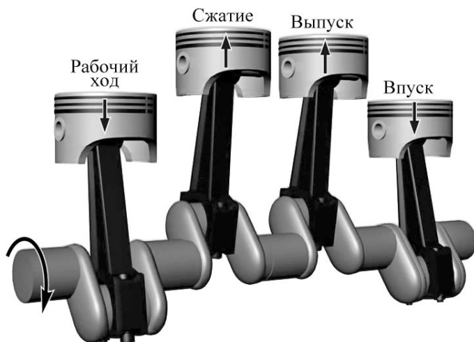
Рис. 2.7. Порядок работы четырехцилиндрового двигателя
