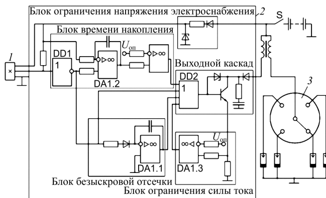
Рис. 8.29. Бесконтактная система зажигания: 1 – датчик Холла; 2 – электронный коммутатор; 3 – распределитель
