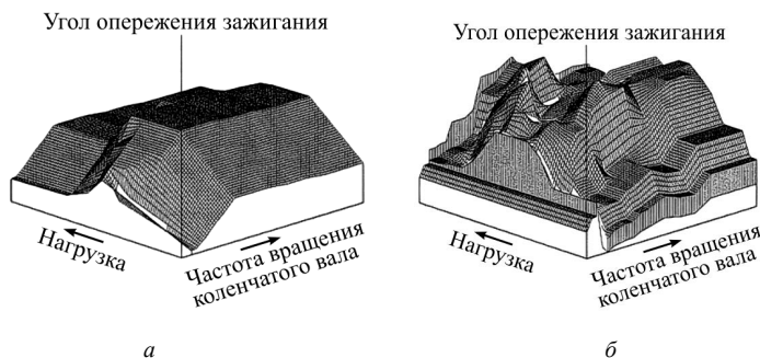
Рис. 7.10. Зависимость угла опережения зажигания от нагрузки и частоты вращения коленчатого вала двигателя: а – механическая система с центробежным и вакуумным регуляторами; б – электронно-оптимизированная система
