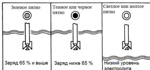
Рис. 8.6. Принцип работы индикатора заряженности
