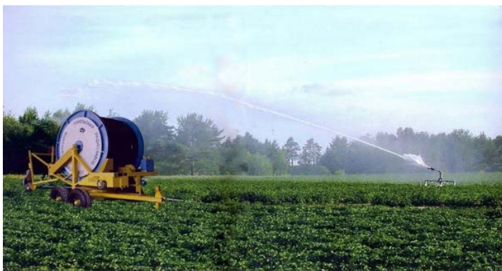
Рис. 2.11. Передвижная барабанно-шланговая дождевальная машина в работе
