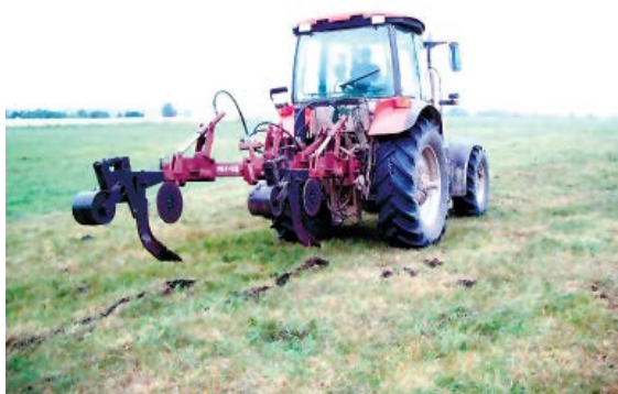
Рис. 10.5. Рыхлительное оборудование РКЛ-50 на базе рамы плуга ПГП-3-40Б в агрегате с трактором МТЗ-1221
