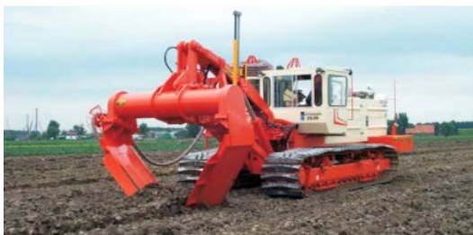
Рис. 11.6. Дреноукладчик с \Delta -плугом
