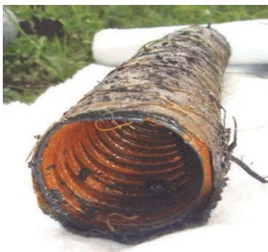
Рис. 11.18. Образец трубы, взятой с одиночной дрены № 26 объекта «Волма», срок эксплуатации 1,5 года
