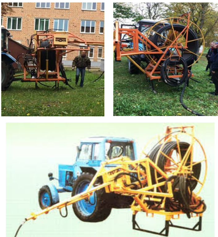
Рис. 11.12. Внешний вид установки в транспортном положении
