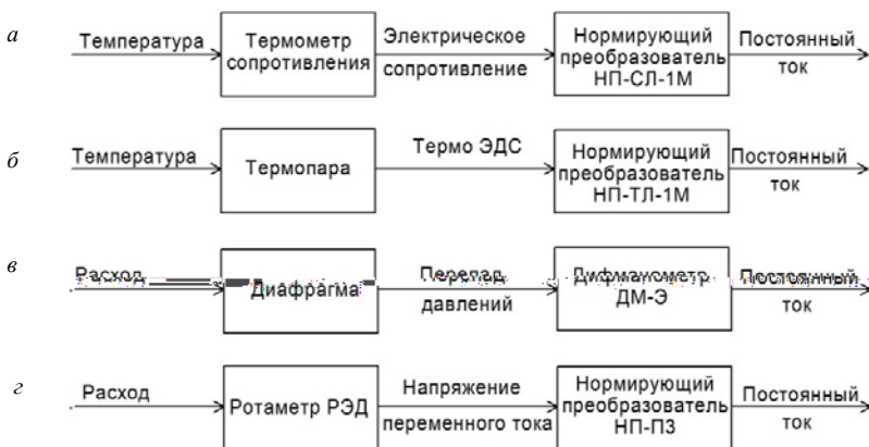
Рис. 4.19. Примеры измерительных цепей микропроцессорного регулятора: а – с термометром сопротивления; б – с термопарой; в – с диафрагмой; г – с ротаметром
