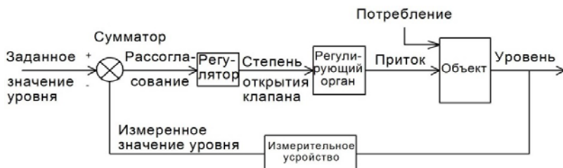
Рис. 4.3. Структурная схема АСР уровня в емкости
