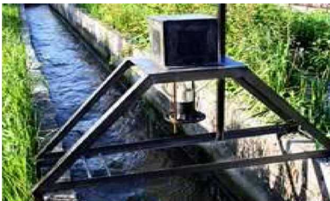
Рис. 3.26. Расходомер Sigma 950 на прямоугольном канале
