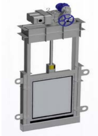
Рис. 9.1. Общий вид плоского затвора с подъемным механизмом
