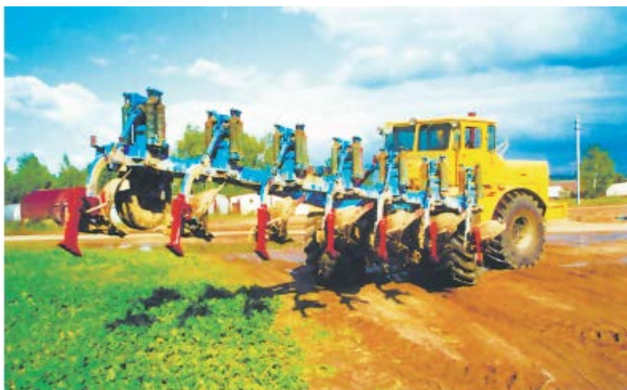
Рис. 10.4. Рыхлители плужной подошвы РПП-20 на плуге ППП-7-40 в агрегате с трактором К-701
