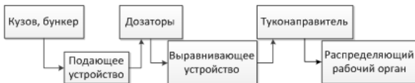
Рис. 2. Элементная схема машин для внесения удобрений
