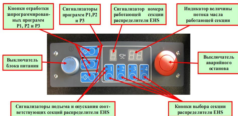
Рис. 3.54. Электронный блок программирования последовательности операций (БПО) ГНС
