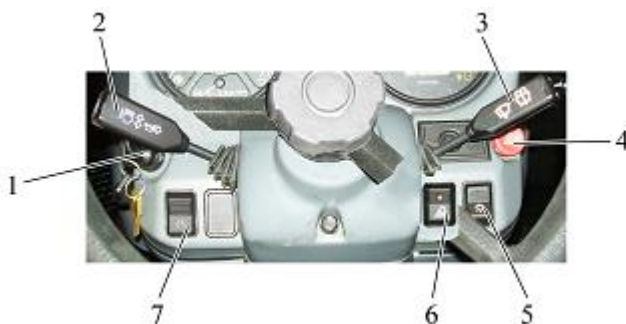
Рис. 3.12. Выключатели и переключатели щитка приборов 1 – выключатель стартера и приборов; 2 – многофункциональный подрулевой переключатель левый; 3 – многофункциональный подрулевой переключатель правый; 4 – выключатель аварийной световой сигнализации; 5 – центральный переключатель света; 6 – выключатель передних рабочих фар, установленных на поручнях; 7 – дистанционный выключатель АКБ
