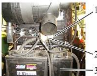
Рис. 3.16. Ручной выключатель АКБ: 1 – кнопка; 2 – ручной выключатель; 3 – аккумуляторная батарея
