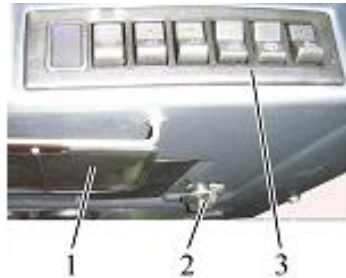
Рис. 3.19. Установка крана отопителя: 1 – противосолнечный козырек, 2 – рукоятка крана отопителя; 3 – блок клавишных переключателей верхнего щитка
