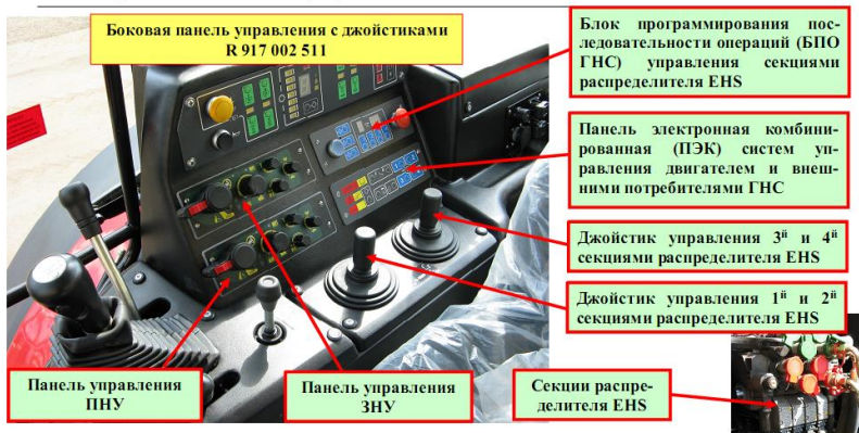
Рис. 3.52. Электронная система управления секциями ГНС с джойстиками R 917 002 511
