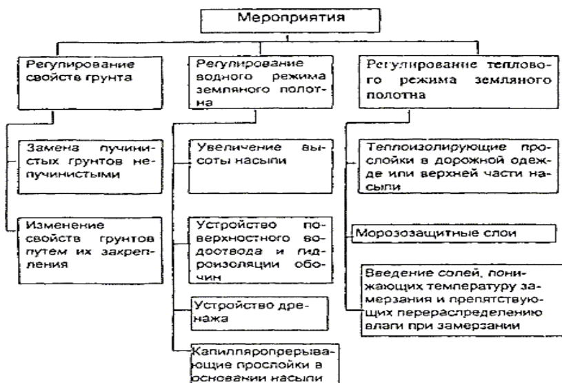
Рис. 6.17. Мероприятия по снижению процесса пучинообразования
