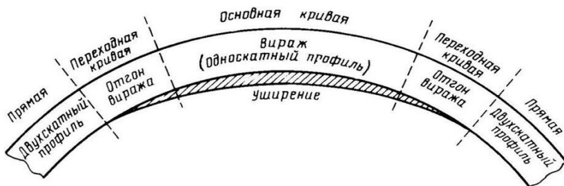
Рис. 3.12. Схема устройства закругления автомобильной дороги с виражом
