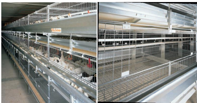
Рис. 4.11. Клеточная батарея Univent Starter с ленточным удалением помета для выращивания ремонтного молодняка
