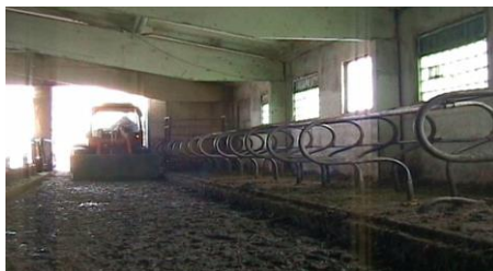
Рис. 2.7. Механизированная уборка навоза
