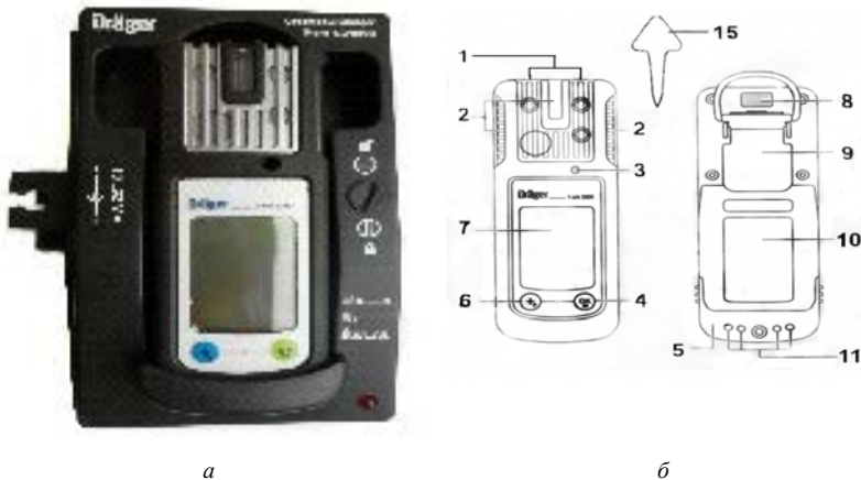
Рис. 22. Комплексный газоанализатор фирмы «Дрегер» для определения углекислого газа, аммиака и сероводорода: a – внешний вид; б – устройство газоанализатора: 1 – поступление газа; 2 – сигнальный светодиод; 3 – звуковое сигнальное устройство; 4 – кнопка ОК; 5 – блок питания; 6 – Кнопка +; 7 – дисплей; 8 – ИК-интерфейс; 9 – зажим для крепления; 10 – паспортная табличка; 11 – зарядные контакты; 12 – индикация измеряемого газа; 13 – индикация измеренного значения; 14 – специальные символы; 15 – инструмент для замены сенсора
