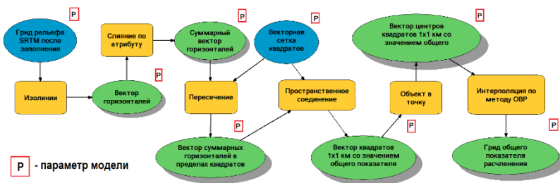
Рис. 6.25. Геоинформационная модель для определения степени расчленения рельефа территории по данным дистанционного зондирования
