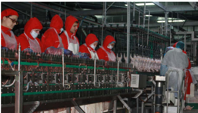
Рис. 21. Автоматическая линия по разделению внутренних органов
