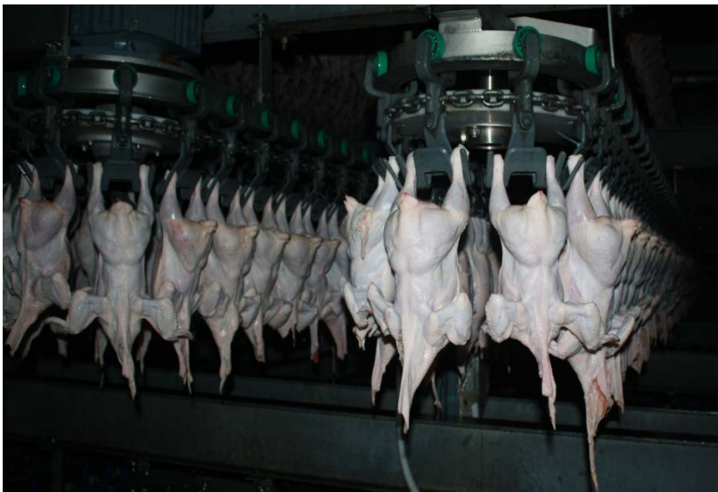
Рис. 28. Воздушное охлаждение тушек
