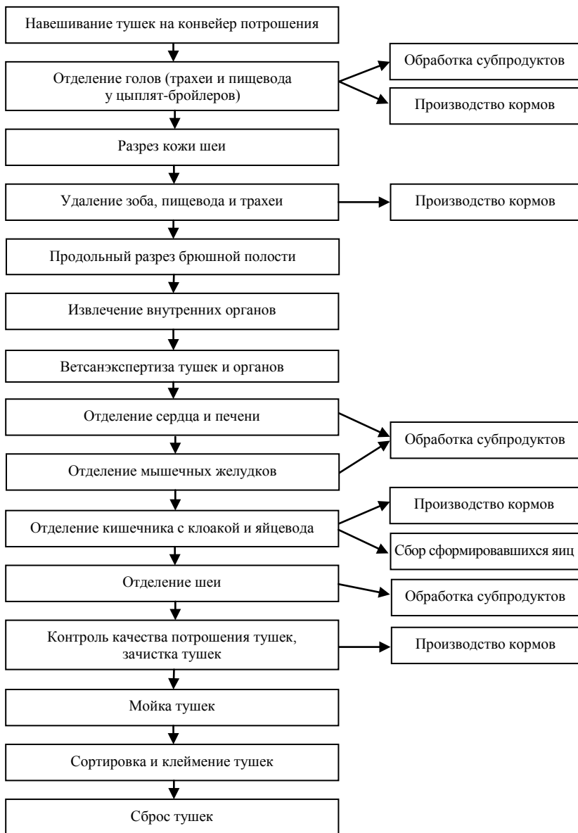
Рис. 17. Технологическая схема потрошения тушек
