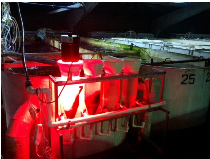
Рис. 114. Лазерно-оптический прибор для инкубации икры «Sturgeon», расположенный на инкубационном аппарате «Вейса»
