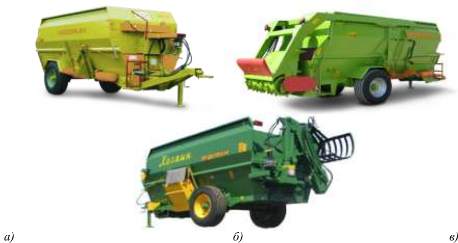
Рис. 1. Линейка кормораздатчиков «Хозяин» с горизонтальным расположением шнеков: а) ИСРК-12; б) ИСРК-12Ф; в) ИСРК-12Г
