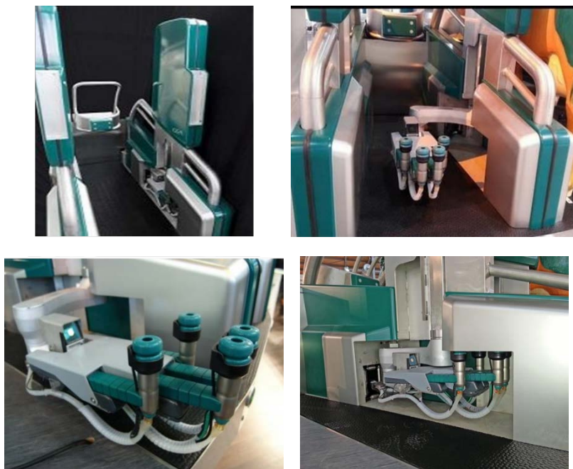
Рис. 6.13. Элементы автоматизированного доильного модуля Dairy ProQ
