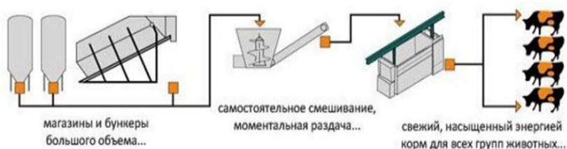
Рис. 4.6. Элементы автоматизированной системы кормления MIX & CARRY
