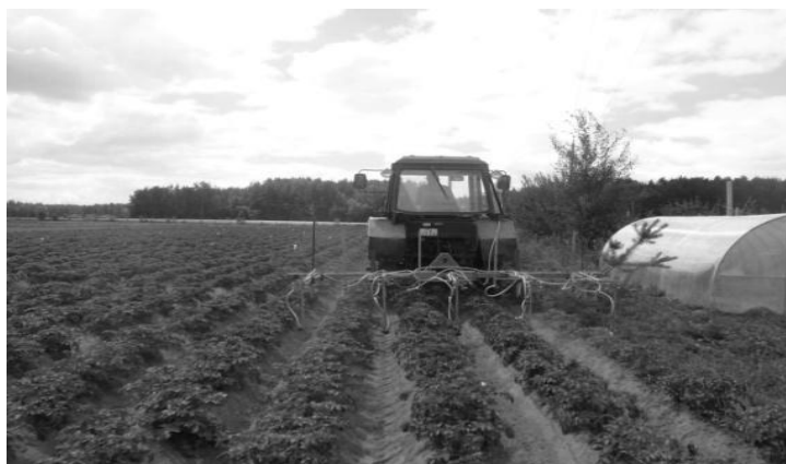
Рис. 4. Опрыскивателя с телескопическими секциями для ленточного или объемного внесения рабочих растворов в работе
