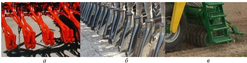
Рис. 1. Сошники, применяемые в посевных льняных машинах: а – анкерные; б – килевидные; в – дисковые
