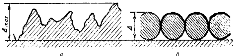
Рис. 10.5. Естественная (а) и эквивалентная зернистая (б) шероховатости
