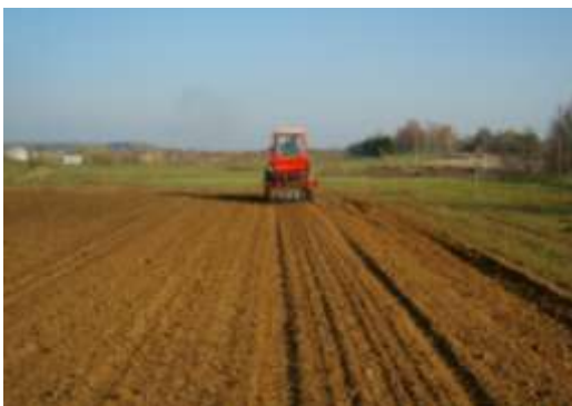
Рис. 3.23. Вид на опытную делянку после прохода селекционной сеялки с двухдисковыми сошниками и коническими бороздообразователями-уплотнителями при скорости движения 14 км/ч
