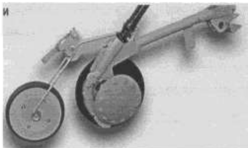
Рис. 1.53. Дискový сошник RoTeC в сочетании с прикатывающим каточком
