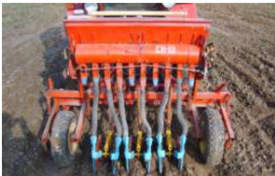
Рис. 3.22. Экспериментальная сеялка с двухдисковыми сошниками (вид сзади) на опытной делянке
