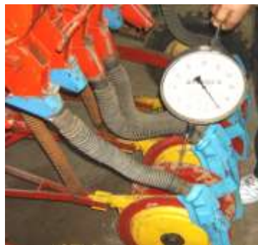
Рис. 3.25. Определение усилия давления пружины на двухдисковый сошник с ребордами-бороздообразователями (на верхнем отверстии штанги)
