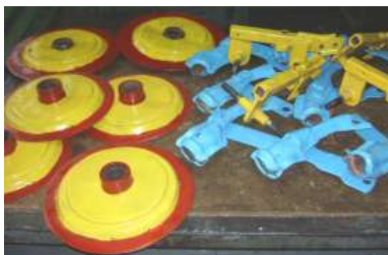
Рис. 3.9. Различные варианты дисков с ребордами-бороздообразователями, корпусов и семянаправителей к экспериментальным двухдисковым сошникам
