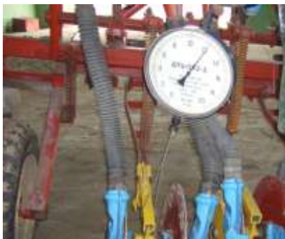
Рис. 3.24. Определение усилия давления пружины на двухдисковый сошник с ребордами-бороздообразователями (на нижнем отверстии штанги)
