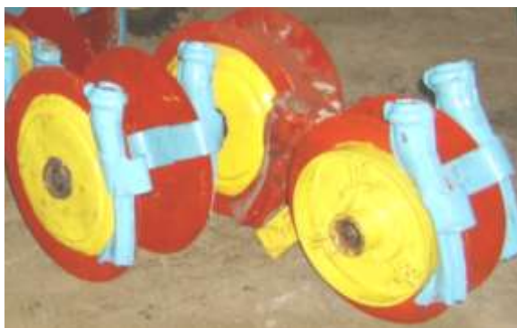
Рис. 3.8. Варианты двухдисковых сошников с различными конструктивными параметрами дисков и реборд
