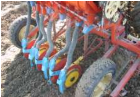
Рис. 3.21. Селекционная сеялка при высеве семян двухдисковыми сошниками с ребрами-бороздообразователями
