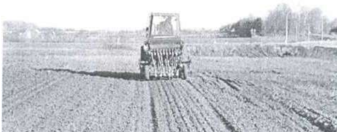
Рис. 4.2. Вид на опытную делянку после прохода трактора Т-25 с модернизированной селекционной сеялкой с экспериментальными двухдисковыми сошниками, расставленными в один ряд с расстоянием между соседними рядками 0,125 м и скоростью движения 4 м/с
