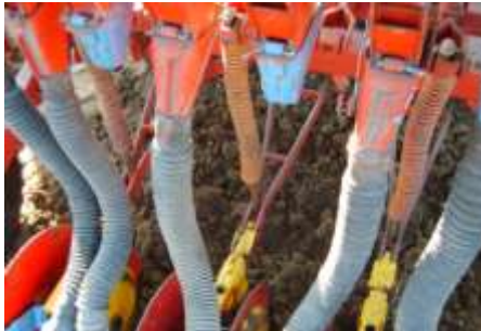
Рис. 3.20. Макетный образец двухдискового сошника без угла атаки дисков при давлении пружины 160 Н (16 кг)
