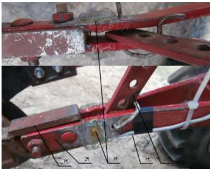
Рис. 3.36. Место установки тензометрических датчиков (по схеме полный мост):
