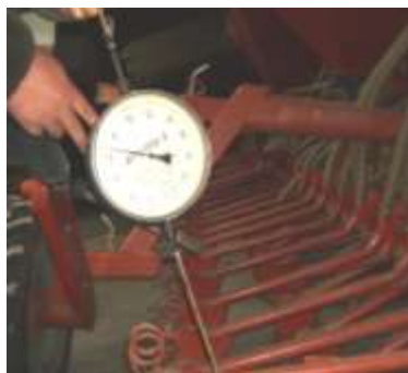
Рис. 3.27. Определение усилия давления пружины на килевидный сошник пневматической сеялки СПУ-6
