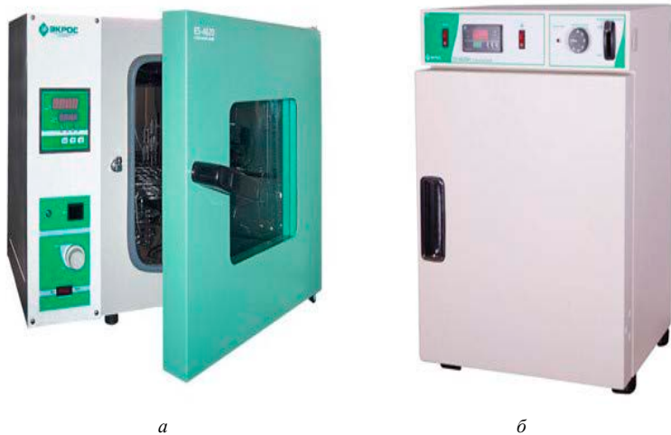
Рис. 6.4. Сушильные шкафы: а – модель ES-4620; б – модель ПЭ-4620М
