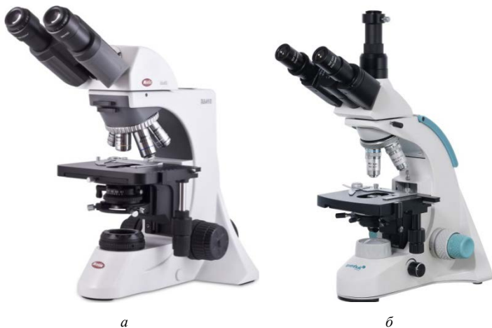
Рис. 1.4. Общий вид темнопольных микроскопов: a – микроскоп BA410; б – микроскоп «Levenhuk 950TDARK»
