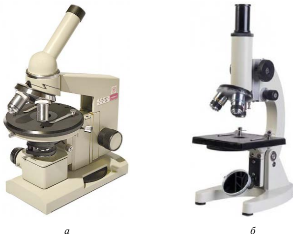
Рис. 1.2. Общий вид световых микроскопов: а – «Биолам Р-12»; б – «Микромед С-12»
