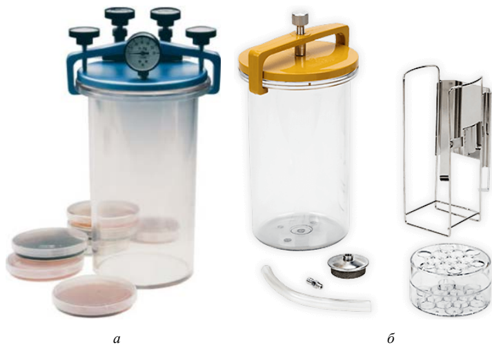
Рис. 7.1. Приборы для культивирования анаэробов: а – прибор Аристовского; б – анаэростат
