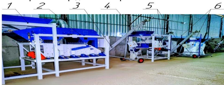
1 – платформа для растаривания биг-бэга; 2 – воздушно-решетный сепаратор ВРС-3000; 3 – шнековый транспортёр тихоходный 4 м; 4 – стол пневмосортировочный прямоточный СПП-1000; 5 – шнековый транспортёр тихоходный 3м; 6 – станция затаривания для биг-бэга
