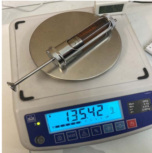
Рис. 1. Оборудование для экспресс-метода определения плотности моторного масла
