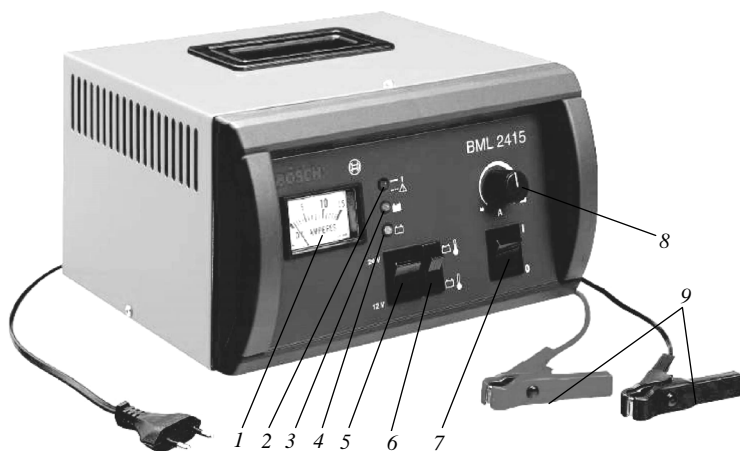
Рис. 2.69. Зарядное устройство Bosch BML 2415: 1 – индикатор силы зарядного тока; 2 – индикатор включения; 3 – индикатор достижения максимального напряжения зарядки; 4 – индикатор зарядки; 5 – переключатель номинального напряжения батареи; 6 – переключатель температуры батареи; 7 – главный выключатель; 8 – регулятор силы зарядного тока; 9 – зарядный кабель с цапгами
