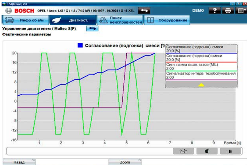
Рис. 2.98. Отображение измеряемых значений для выбранных фактических параметров в графическом виде
