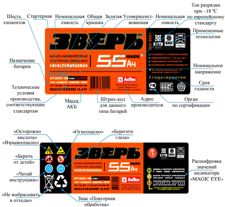
Рис. 2.62. Пример маркировки аккумуляторной батареи
