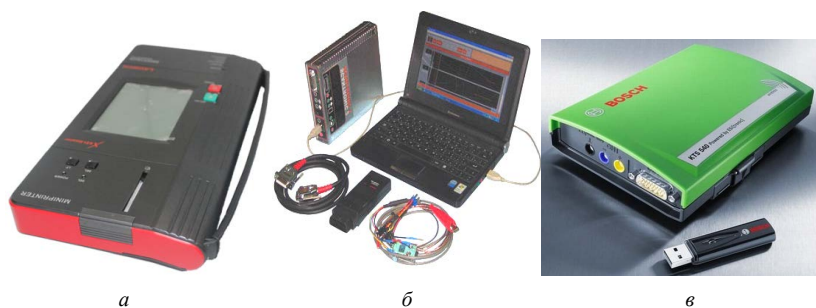
Рис. 2.84. Автосканеры Launch X431 (а), Scantronic II (б), Bosch KTS (в)
