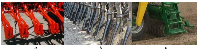
Рис. 1. Сошники, применяемые в посевных льняных машинах: а – анкерные; б – килевидные; в – дисковые
