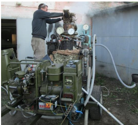
Рис. 1. Загрузка в газогенератор навоза КРС
