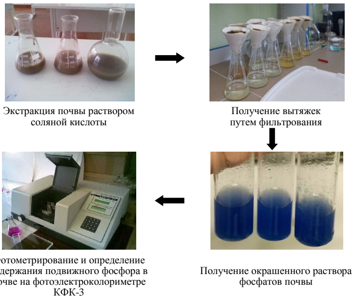
Рис. 1. Алгоритм испытаний почвенных образцов на содержание подвижных форм фосфора по методу Кирсанова
