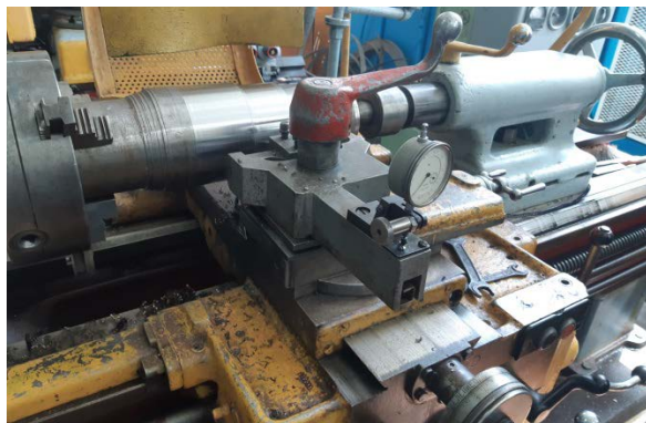
Рис. 1. Установка динамометра ДК-1 на токарный станок
