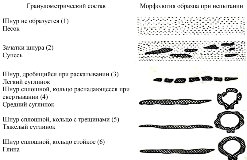
Рис. 5.3. Полевой метод определения гранулометрического состава почвы
