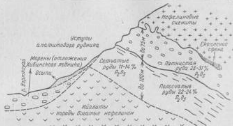
Рис. 26. Схематический разрез Купевсумчорского месторождения апатитов.
