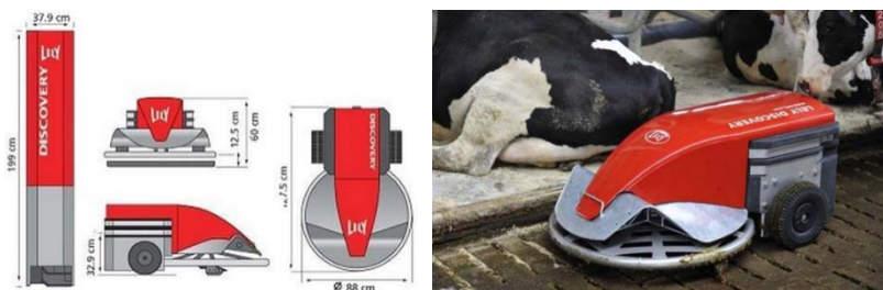
Рис. 5.5. Зарядная станция и навозоуборочный робот Discovery
