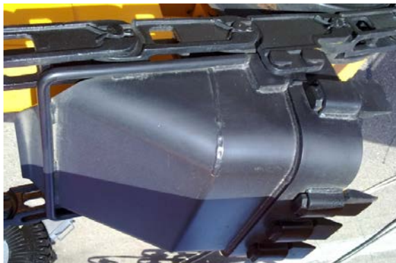
Рис. 2. Ковш экскаватора-дренукладчика ЭТЦ-203
