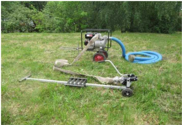
6.6. Установка промывки трубопроводов УПТ-75
