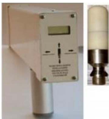
Поисковый комплект трасс дренажных коллекторов ПУ-2 . 3.15
