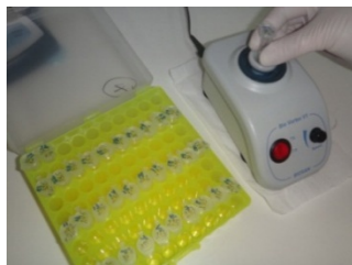
Рис. 21. Перемешивание раствора на вортексе
