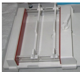
Рис. 24. Заливочный столик с гребенками для агарозного геля
